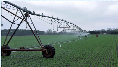
Abb. 1: Funktionstest der für eine teilflächenspezifische Bewässerung nachgerüsteten Kreisberegnungsanlage beim OG-Partner Agrar GmbH Altdöbern.
